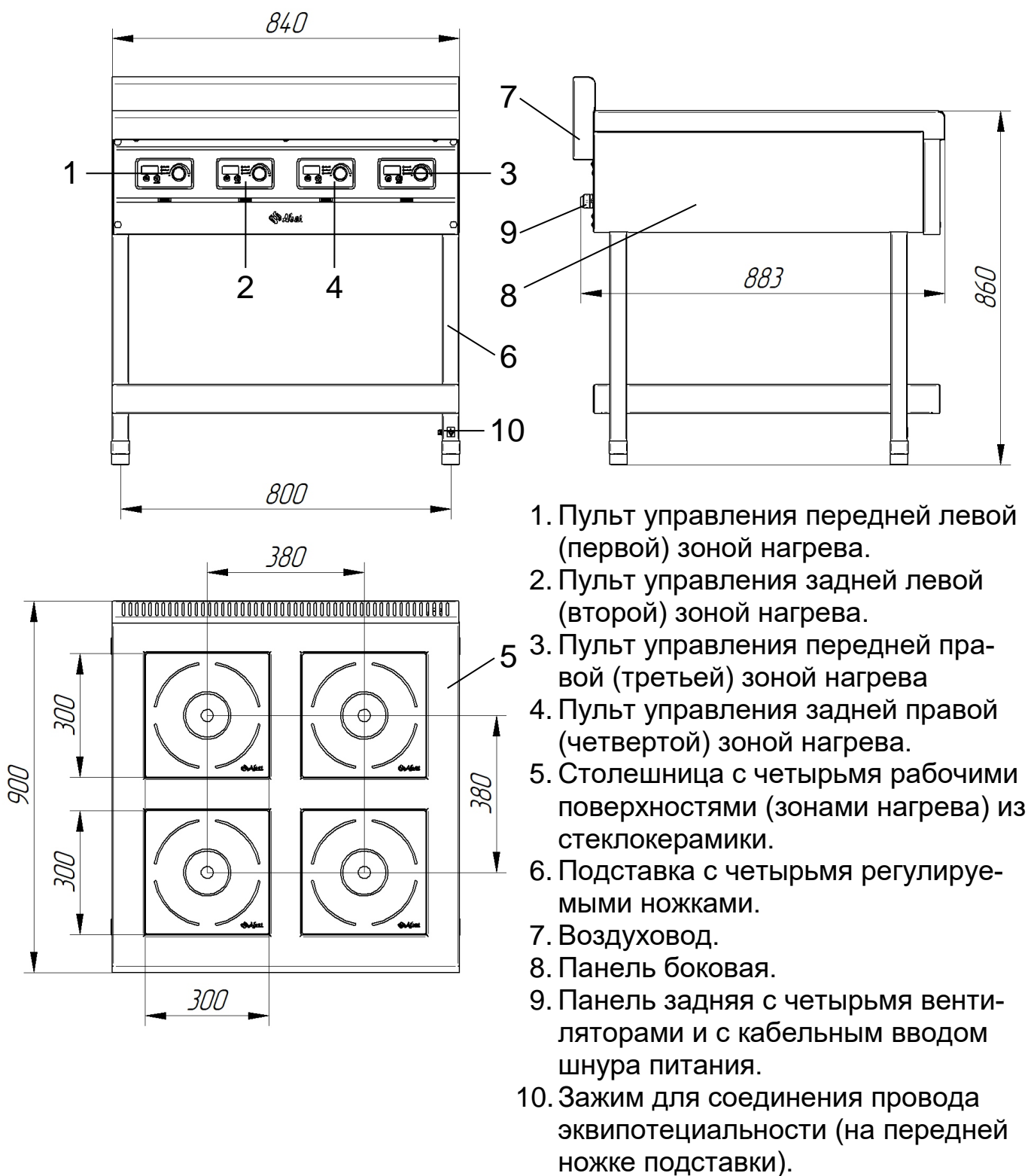
Рис. 2. Общий вид и размеры плит КИП-49П-3,5, КИП-49П-3,5-01, КИП-49П-5,0, КИП-49П-5,0-01
